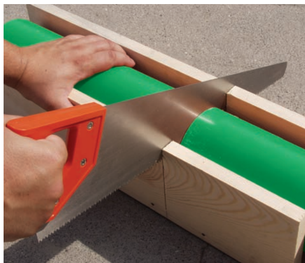
Рис. 3 Резка с использованием стусла
